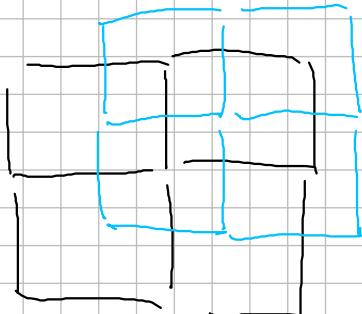
Damit kann man das Yee Schema als Finites Integrationsverfahren angewandt auf die Seitenflächen eines Würfels mit Kanten Länge  $\Delta x, \Delta y, \Delta z$  verstehen.
